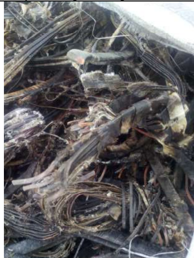
Принимать нельзя – не снята оболочка (остатки внешней изоляции)
