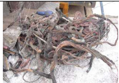
Принимать нельзя – не снята оболочка (остатки внешней изоляции)
